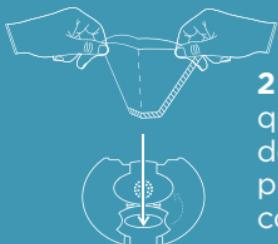
**2 a 4 tazas:** Baje solamente la lengüeta que tiene una abertura ovalada dentro del cesto de colar. Coloque el extremo puntiagudo de un filtro en forma de cono #3 o un filtro #4 doblado a la mitad, dentro de la abertura ovalada.
