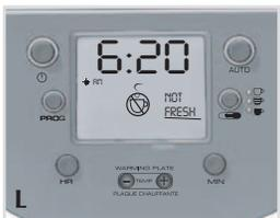
14. Après 20 minutes, les mots « **NOT FRESH** » et une nouvelle icône apparaissent à l'écran pour indiquer que le café n'est plus frais (L).
