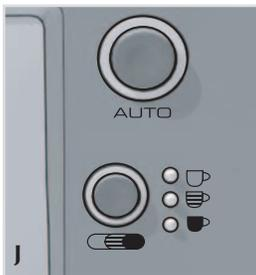
10. Appuyer sur le bouton de sélection du degré d'infusion (**BREW STRENGTH**) et sélectionner un des trois degrés d'infusion suivants (J) :
