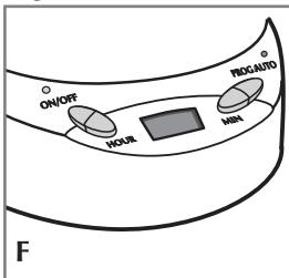
1. Pour régler l'horloge à l'heure juste. Enfoncer la touche des heures (HOUR) jusqu'à ce que l'heure soit affichée. Surveiller le petit point dans le coin supérieur gauche de l'affichage qui indique l'heure après midi. Enfoncer la touche des minutes (MIN) pour régler celles-ci. Lorsque l'horloge indique l'heure juste, elle continue de fonctionner jusqu'à ce que la cafetière soit débranchée ou qu'il y ait une panne de courant. On peut seulement régler l'heure lorsque l'affichage clignote (F).
