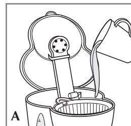
3. Vierta agua fría hasta el nivel que indica 5 tazas en el tanque de agua (A). Cuélela según las indicaciones de la sección "PREPARACIÓN DEL CAFÉ", pero no agregue café molido. Una vez que se cuele el agua, apague la cafetera y deseche el agua de la jarra.
