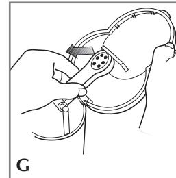
2. Pour nettoyer l'intérieur du couvercle du réservoir, et du panier ouvrir le couvercle en le laissant reposer en position ouverte. Retirer le diffuseur d'eau du guide, essuyer les surfaces à l'aide d'un chiffon humide, puis remettre le diffuseur d'eau sous le guide et refermer le couvercle (G).
