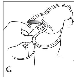
2. Para limpiar el interior de la tapa del tanque y del cesto de colar, abra la tapa, permitiendo que descance en posición abierta. Hale y retire el rociador de agua por debajo de la guía. Limpie las superficies con un paño humedecido, coloque el rociador de agua debajo de la guía y cierre la tapa (G).
