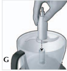
2. Prendre le couteau par la tige et l'insérer dans l'axe d'entraînement de l'appareil (**G**).
