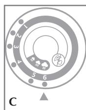
2. Gire o dial para seleção de tecido até a posição desejada (entre 4 e 6) para seu tecido (C). Veja o guia de tecido no calcanhar de apoio e leia a etiqueta de sua roupa para determinar o tipo de tecido. A luz indicadora de temperatura brilha até o ferro atingir a temperatura apropriada. Daí ela alterna entre os ciclos ligado [on] e desligado [off] durante a passação.
