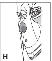
1. Gire el selector de tejidos a la posición , y desconecte la plancha. Coloque la plancha sobre su talón y permita que se enfrie bien.
