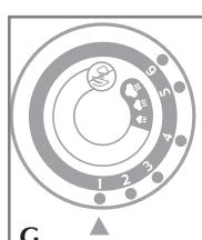
2. Gire o dial para seleção de tecido até a posição apropriada para seu tecido (**G**). Veja o guia de tecidos no calcanhar de apoio e leia a etiqueta da roupa para determinar o tipo de tecido. A luz indicadora de temperatura brilha até atingir a temperatura apropriada. Daí, ela alterna entre os ciclos ligado [on] e desligado [off] durante a passação.
