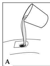
1. Incline o ferro e com um caneco limpo de medida, despeje a água orifício adentro até atingir o nível máximo [MAX] no reservatório de água (A). Não encha demais. Reabasteça conforme necessário.
