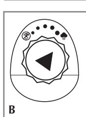
2. Insira o plugue na tomada. A luz indicadora de temperatura brilha quando o ferro atinge a temperatura selecionada.
