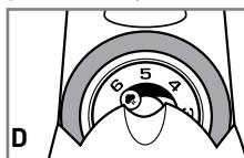
2. Una vez que determine el tipo de tejido, gire el selector de tejidos que está en la parte delantera del mango de la plancha, en dirección de las manecillas del reloj y seleccione el nivel de temperatura apropiado (**D**).
