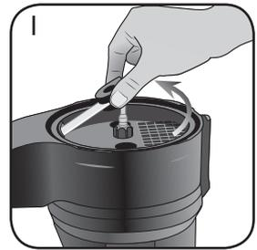
11. Una vez que haya terminado de cortar en cubos, apague el aparato, desenchúfelo y luego retire la tapa.
