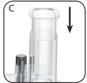
**Importante:** Para su protección, este aparato cuenta con un sistema de entrecierre. El aparato no funcionará a no ser que que el recipiente de procesamiento y la tapa estén asegurados correctamente en posición.
