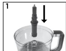
Con la unidad desenchufada del tomacorriente, coloque el recipiente sobre la base y coloque el vástago central en el recipiente.
