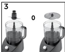
Coloque la cuchilla o el disco sobre el vástago central.
