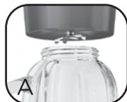
2. Placer la base du récipient avec l'assemblage de lames sur le récipient et tourner dans le sens horaire jusqu'à ce que ce soit bien serré (A).
