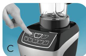
**Important :** ne pas tenir enfoncés les boutons de réglage de la vitesse ou d'impulsion pour mélanger. Le fait d'appuyer sur la touche pendant plus de 30 secondes générera une erreur. Débrancher l'appareil pour réinitialiser l'appareil.
