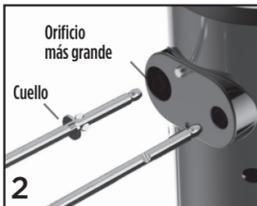
**NOTA:** Para instalar los batidores y los ganchos para masa, inserte el accesorio con el cuello dentro del orificio grande.
